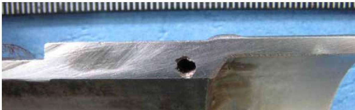
Slika 3: Rupičasto oštećenje u području dijela izrađenom od čelika AISI 201
