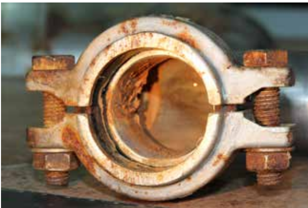
Slika 1: Oštećenja cjevovoda od nehrđajućih čelika
