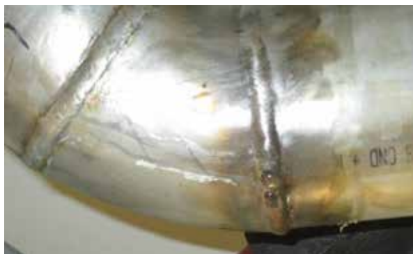
Slika 5: Oštećenja na sustavu cjevovoda u području zavarenih spojeva
