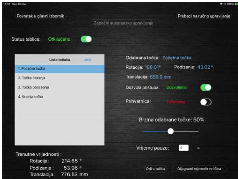
Slika br. 5: Prikaz zaslona automatskog upravljanja aplikacije EHRM PRO (Upravljački program je načinjen u Zavodu za robotiku i automatizaciju proizvodnih sustava u okviru diplomskog rada studenta Dalibora Žgele)
