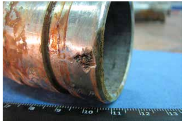
Slika 1: Oštećenja cjevovoda od nehrđajućih čelika
