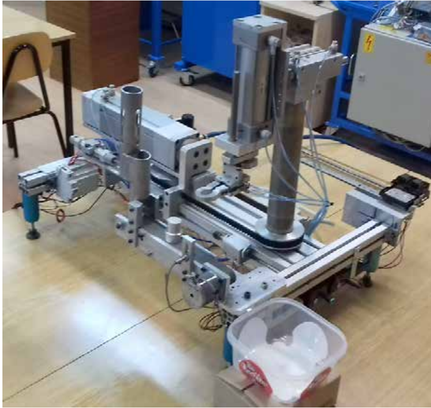
Slika br. 6: Elektropneumatski manipulator s transportnim sustavom (Manipulator je načinjen u Zavodu za robotiku i automatizaciju proizvodnih sustava u okviru diplomskog rada studenta Kristijana Pucaka)
