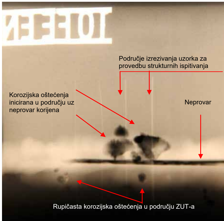
Slika 7: Neprovar korijena zavarenog spoja i korozijska oštećenja inicirana u području uz neprovar te rupičasta korozijska oštećenja u području zone utjecaja topline
