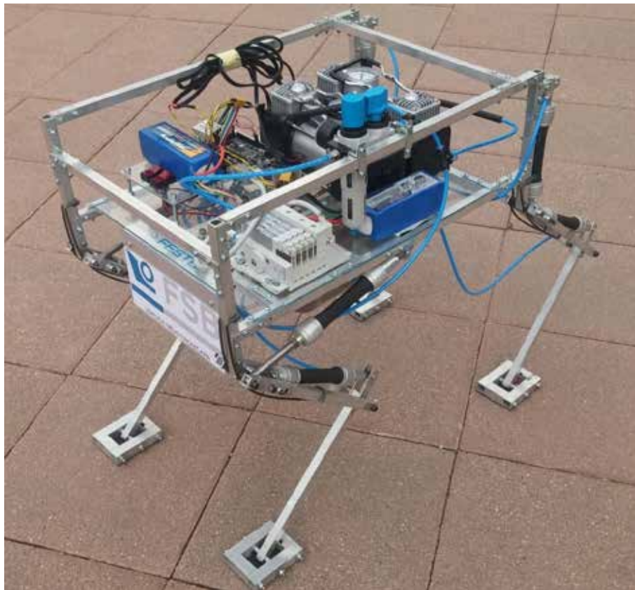
Slika br. 7: Hodajući četveronožni robot pokretan umjetnim pneumatskim mišićima (Robot je načinjen u Zavodu za robotiku i automatizaciju proizvodnih sustava, studenti: Dominik Srećić, Hrvoje Brezak, Vedran Tatalović i Viktor Mandić)
