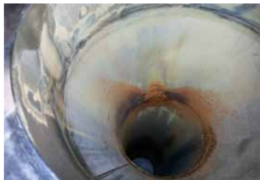
Slika 5: Oštećenja na sustavu cjevovoda u području zavarenih spojeva
