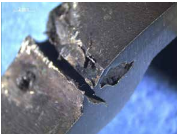
Slika 8: Stereomikroskopske snimke u području oštećenja. Uočavaju se područja neprovarenog korijena zavarenog spoja kao i naknadno nastala korozijska oštećenja.
