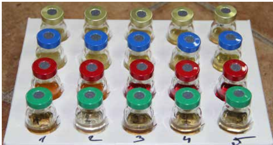
Slika 9: Mikrobiološko ispitivanje uzorka vode korištenjem MICkit3 podloga za nacjepljivanje
